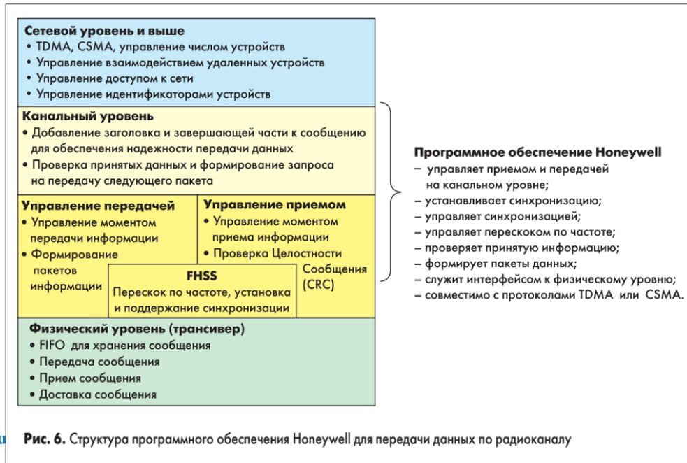
**Рис. 6.** Структура программного обеспечения Honeywell для передачи данных по радиоканалу
