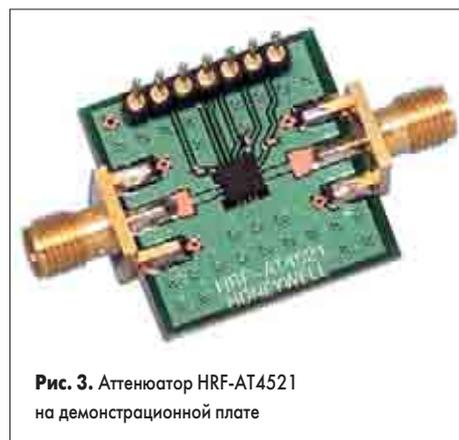
Рис. 3. Аттенюатор HRF-AT4521 на демонстрационной плате
